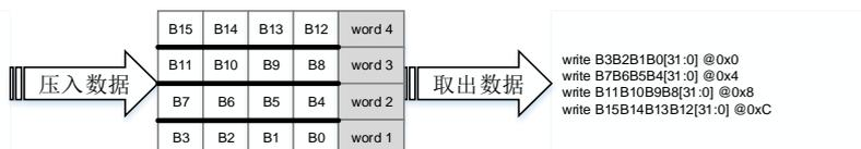
假设当 CNT 被设置为 8，PWIDTH 为‘01’，PNAGA 和 MNAGA 被置 1。对于不同的 WIDTH，DMA 的传输操作如 [图 16-5. PWIDTH 为‘01’时，数据的打包/解包](#) 所示。
