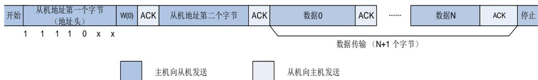
图 26-5. 7 位地址的 I2C 通讯流程（主机发送）
