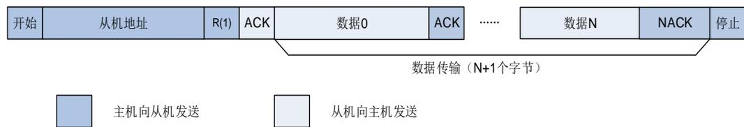
在 10 位寻址模式中，配置 HEAD10R 位可以选择执行完整的寻址序列或只发送地址头。当 HEAD10R = 0，执行完整的 10 位地址寻址读序列 START + 10 位地址头（写）+ 第二个地址字节 + RESTART + 10 位地址头（读），如 [图 26-7. 10 位地址的 I2C 通讯流程（主机接收，HEAD10R = 0）](#) 所示。
